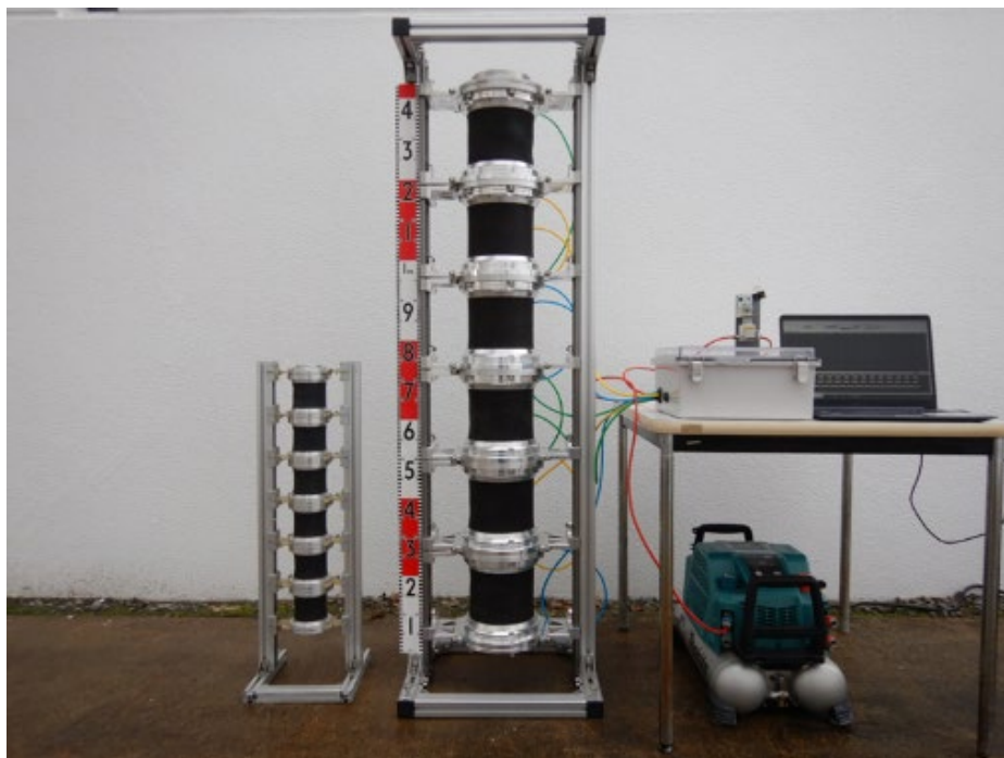
図1 土砂搬送用ぜん動ポンプ（左：小型機 右：大型機）
